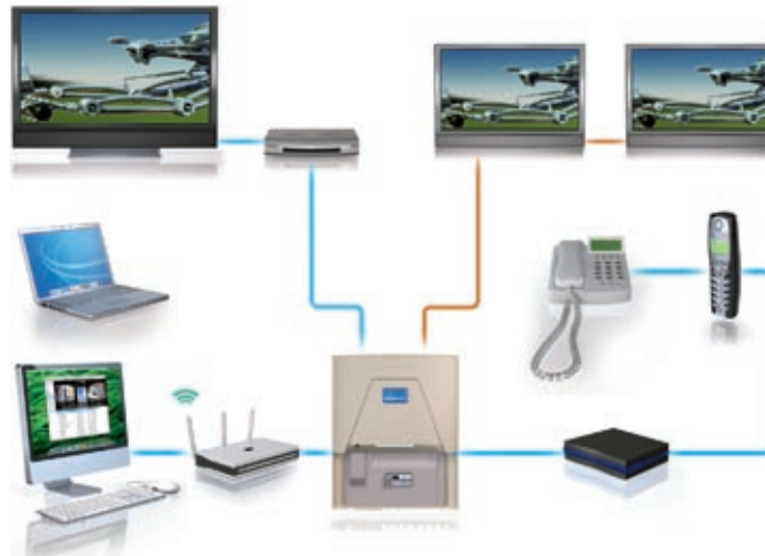
Datornät, kabel-TV nät, telefontät och IP-TV ansluten till en mediabox i Karlstads Stadsnät
